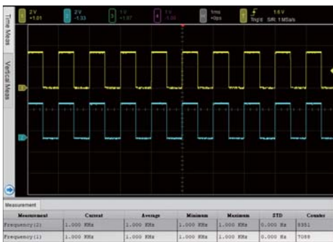
示波器测量 1KHz · 2.5Vpp 的方波
